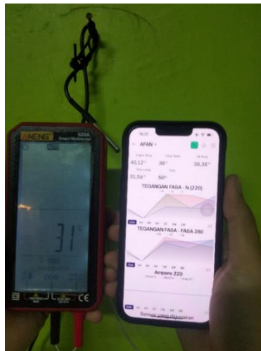
Gambar 2. Pengujian sensor suhu ruangan dengan alat ukur
