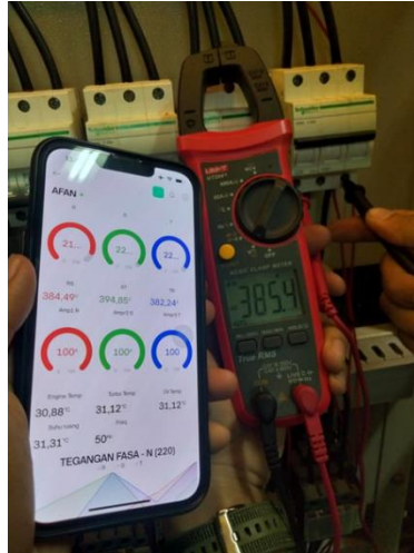
Gambar 6. Pengujian sensor PZEM – 004T (tegangan) dengan calmp meter Tabel 6. Hasil pengujian sensor PZEM – 004T (tegangan) dengan calmp meter
