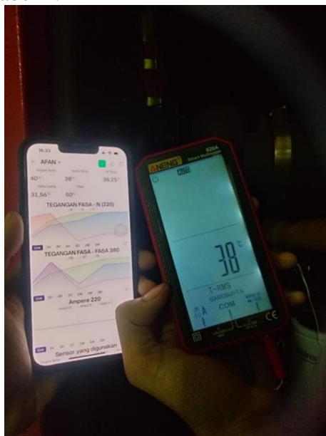
Gambar 4. Pengujian sensor suhu oli dengan alat ukur
