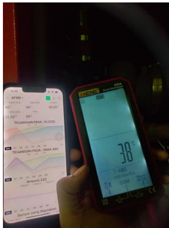
Gambar 5. Pengujian sensor suhu turbo dengan alat ukur
