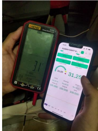
Gambar 1. Pengujian sensor suhu panel dengan alat ukur
