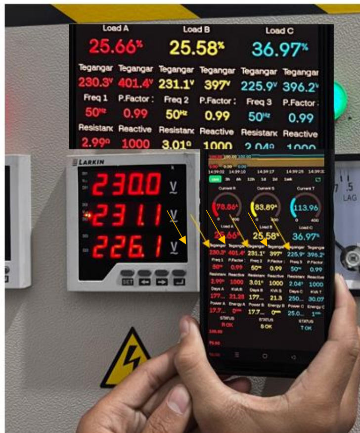
Gambar 1. Perbandingan display panel dengan monitoring tegangan
