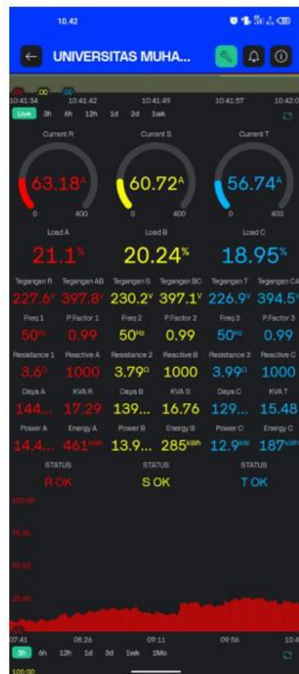
Gambar 4. Hasil monitoring mesin genset 250 kVA pada aplikasi blink
