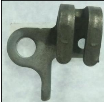
Gambar 5 Platting Tidak Merata
