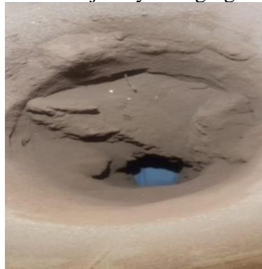
Gambar 9. Salah satu sisi penempelan (tidak terjangkau Air blaster)
