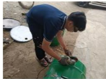
Gambar 2.4 3 Pemotongan Bagian Samping Ventilasi Drum
