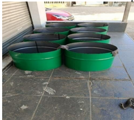
Gambar 3 Drum 200L Setelah dipotong Menjadi dua bagian Menggunakan alat potong gerinda Pembuatan dan Instalasi
