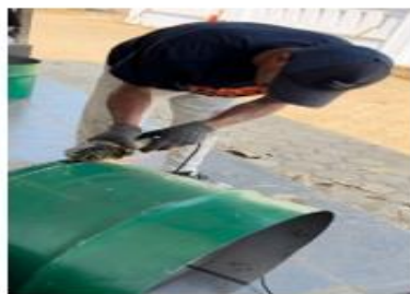
Gambar 2.4 2 Pemotongan Bagian Bawah Drum
