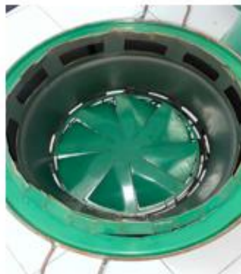
Gambar 2.4.8 Proses Penyatuan komponen drum yang sudah dipotong dan dibentuk, sehingga menjadi struktur tong pembakaran dengan desain minim asap.
